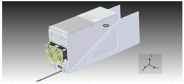
Рисунок Г.27. Блок с модулями (усилен шасси и стенками) по оси Z
