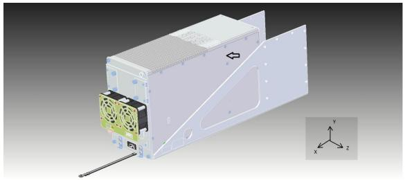
Рисунок Г.31 - Блок с модулями (усилен шасси и стенками) по оси Z (стрелкой указано место установки датчика).
