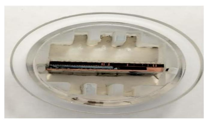
Рисунок 3.7 - Общий вид микрошлифа микросхемы D1 (EP2S60F1020I4N ALTERA) модуля МВ $\Phi$
