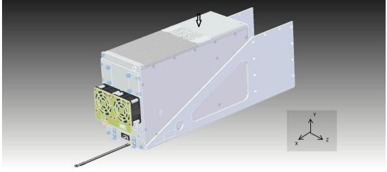
Рисунок Г.25 - Блок с модулями (усилен шасси и стенками) по оси Y (Стрелкой указано место установки датчика)
