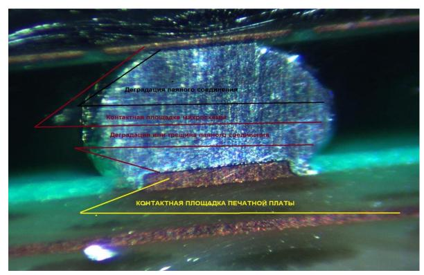
Рисунок Е.5 - Изображение микрошлифа образца №2
