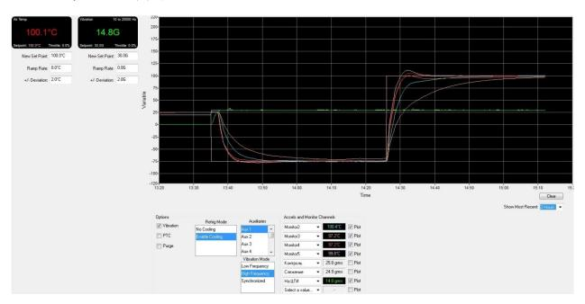
Рисунок Д.8 - График циклического изменения температуры
