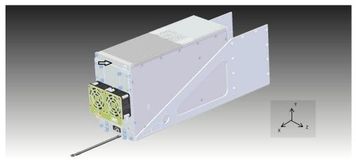
Рисунок Г.7 - Блок с модулями (МВИ-4 с X-планкой) по оси X (стрелкой указано место установки датчика)
