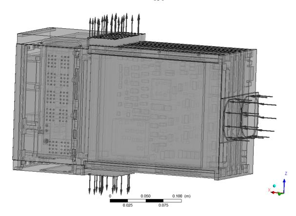
Рисунок В.2 - 3D-модель воздуха внутри БКД
