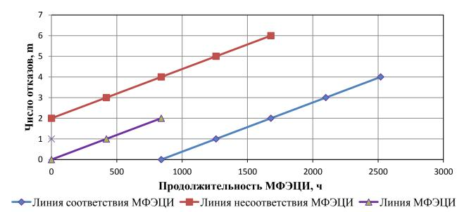
Рисунок 3.5 - График приемочного контроля МФЭЦИ на безотказность
