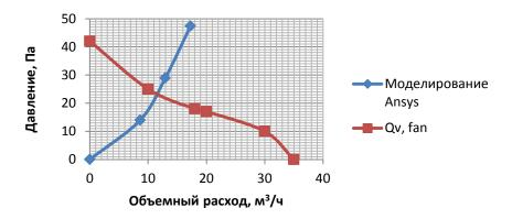
Рисунок 3.2 - Зависимость давления от объемного расхода воздуха
