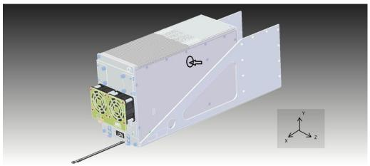
Рисунок Г.9 - Блок с модулями (датчик на модуле процессоровВИ-4 с X-планкой) по оси Z (стрелкой указано место установки датчика на модуле)
