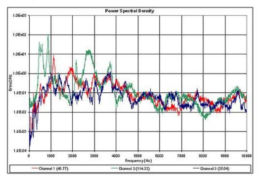
Рисунок Д.7 - Определение предельного (максимального) уровня воздействия ШСВ (50  $G_{rms}$ , от 2  $\Gamma$ ц до 10  $\kappa$  $\Gamma$ ц)
