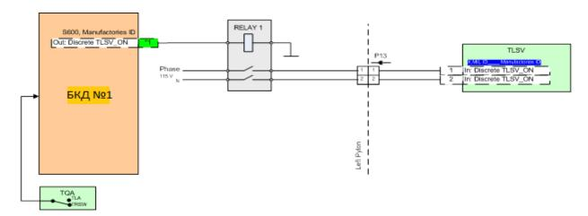
Рисунок 1.7 - Схема взаимодействия блока БКД №1 в части клапана «TLSV»
