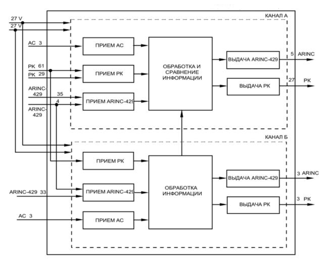
Рисунок 1.1 - Типовая структура организации блоков цифровой системы управления
