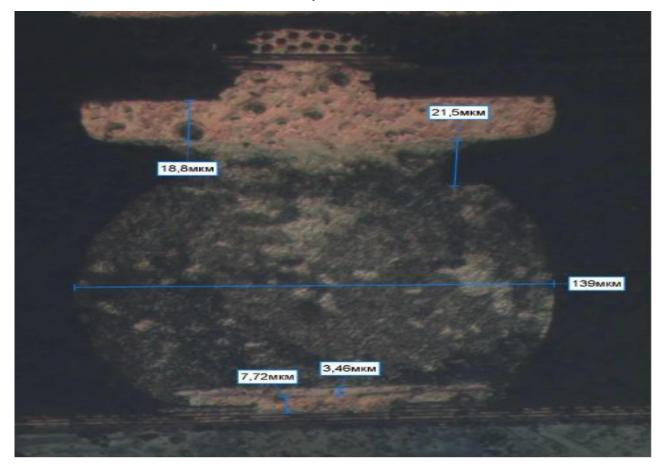
Рисунок 3.8 - Снятие микрошлифа микросхемы D1 модуля МВФ методом разрушающего контроля (п.7.3.8.1 IPC 7095A)
