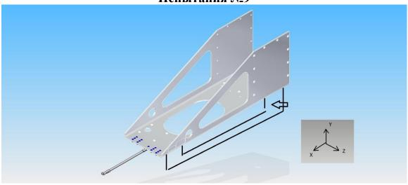
Рисунок Г.17 - Рама без блока (датчик на приспособление для установки рамы на стол) по оси Z (стрелкой указано место установки датчика)
