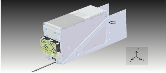
Рисунок Г.13 - Блок с модулями (датчик на раму) по оси Z (стрелкой указано место установки датчика)
