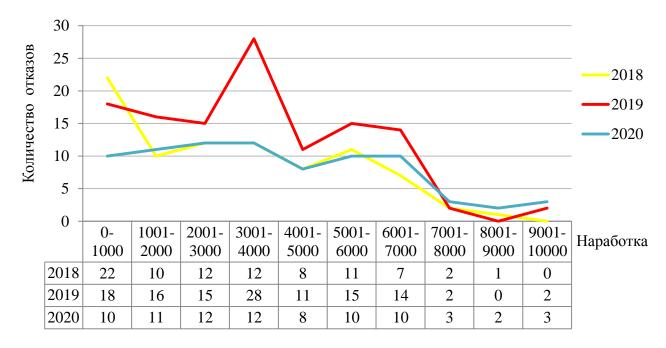
Рисунок 1.3 - Распределение отказов, выявленных в эксплуатации, по наработке изделия в абсолютных единицах
