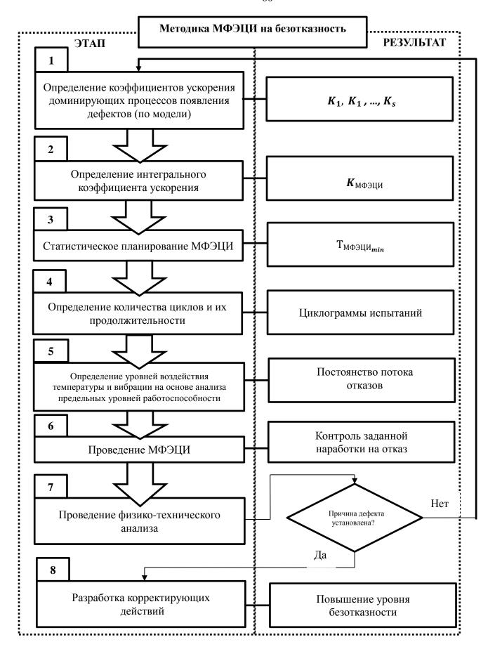
Рисунок 2.1 - Методика многофакторных эквивалентно-циклических испытаний на безотказность элементов и устройств БЦСУ воздушным судном
