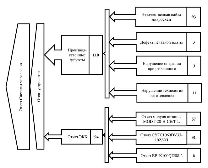
Рисунок 1.9 - Анализ отказов в эксплуатации на примере типового блока БЦСУ
