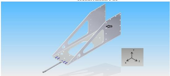
Рисунок Г.15 - Рама без блока по оси Z (стрелкой указано место установки датчика)
