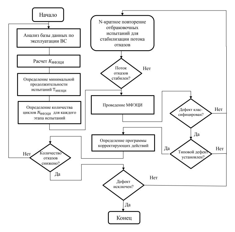
Рисунок 4.3. Алгоритм повышения надежности бортовых цифровых систем управления воздушным судном в эксплуатации
