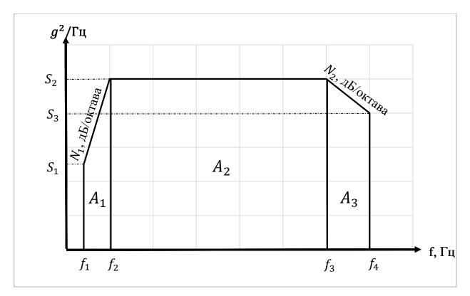
Рисунок 2.4 - ШСВ с переменной спектральной плотностью
