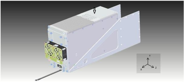
Рисунок Г.19 - Блок с модулями по оси Y (стрелкой указано место установки датчика)
