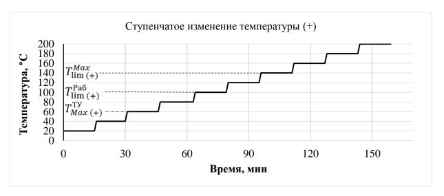
Рисунок 2.6 - Типовой график испытаний ступенчатого изменения в области повышенных температур по процедуре HALT
