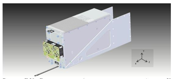
Рисунок Г.29 - Блок с модулями (усилен шасси и стенками) по оси X(стрелкой указано место установки датчика)
