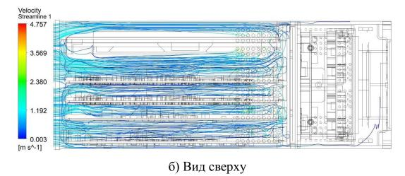
Рисунок 3.3 - Линии движения частиц потока воздуха при расходе 8,6 м<sup>3</sup>/ч
