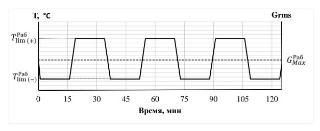
Рисунок 2.9 - Типовой график проведения комбинированного воздействия
