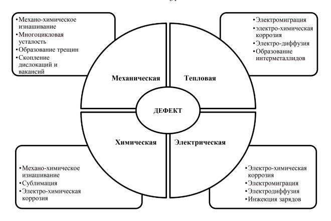
Рисунок 1.12 - Механизмы отказа элементов БЦСУ при воздействие различных видов энергии
