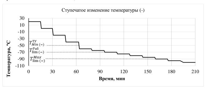
Рисунок 2.5 - Типовой график испытаний ступенчатого изменения в области отрицательных температур по процедуре HALT
