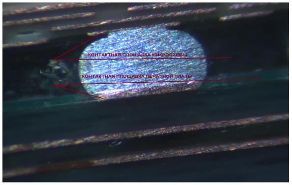
Рисунок Е.4 - Изображение микрошлифа образца №1
