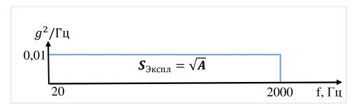
Рисунок 2.3 - ШСВ с постоянной спектральной плотностью
