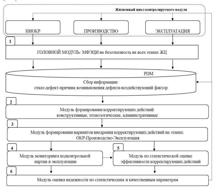
Рисунок 4.2 - Схема поддержки инженерных решений с помощью программного комплекса обеспечения надежности БЦСУ на всех этапах жизненного цикла
