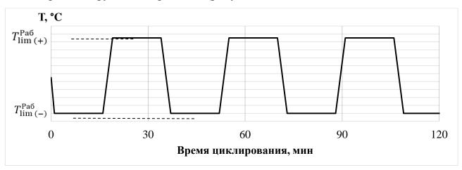
Рисунок 2.8 - Типовой график циклического изменения температуры по процедуре HALT
