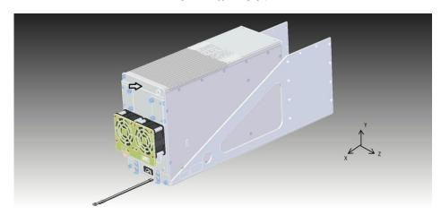
Рисунок  $\Gamma$ .1 - Блок без модулей по оси X (стрелкой указано место установки акселерометра).
