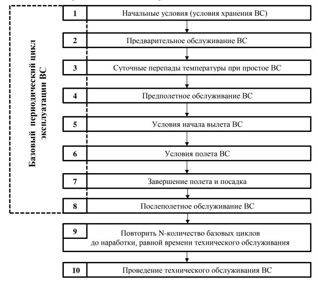
Рисунок 2.2 - Базовый годовой цикл эксплуатации БЦСУ на борту ВС В общем случае методика построения циклограмм будет следующая:
