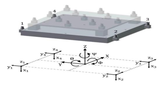
Рисунок 1.13 - Многоосная широкополосная вибрация в НАLТ-камере
