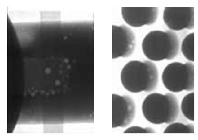
Рисунок 1.10 - Рентгеноскопия BGA-шариков, соединяющих микросхему EP2S60F1020I4 Altera с печатной платой
