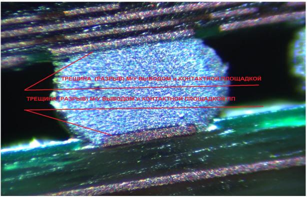
Рисунок Е.6 - Изображение микрошлифа образца №3.
