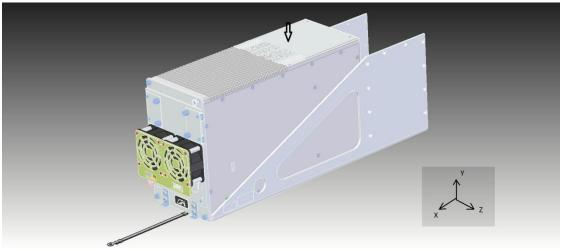
Рисунок Г.21 - Блок без модулей по оси Y(стрелкой указано место установки датчика)
