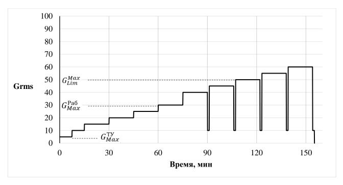
Рисунок 2.7 - Типовой график испытаний на ШСВ по процедуре НАLТ
