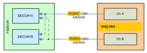
Рисунок 1.6 - Схема взаимодействия БКД №1 с вычислителями «DECU»
