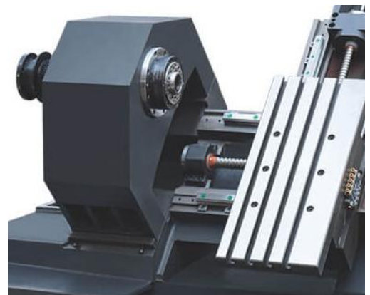
Рисунок 1.11. Шпиндельный узел станка с ЧПУ SCK-46CY (Китай)
