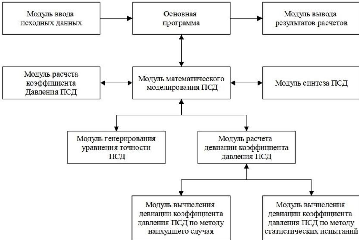
Рисунок 4 – Структурная схема системы автоматизированного параметрического синтеза приемников статического давления
